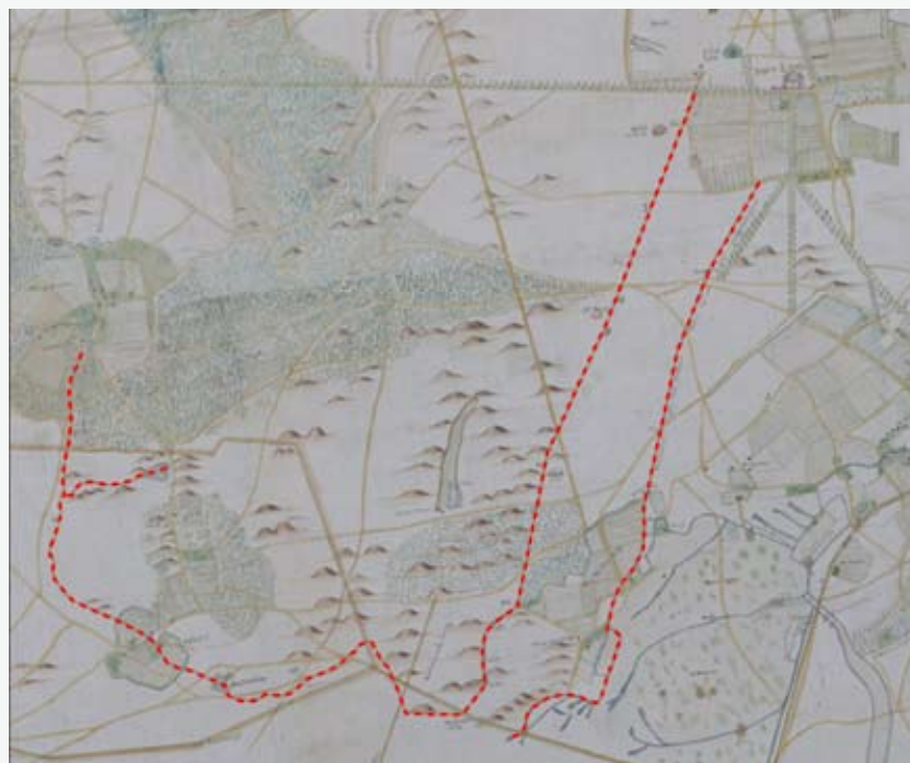
Loo en waterleiding: dit is een kaart van Leenen uit 1748 waarop in rood is aangegeven de twee waterleidingen die aangelegd zijn voor de Koningsfontein op Het Loo. Dit in opdracht van Koning stadhouder Willem III
